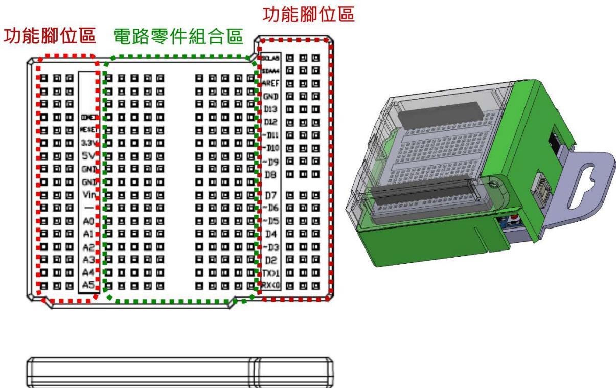
如上圖照片所示為麵包板，麵包板上有許多洞洞，
